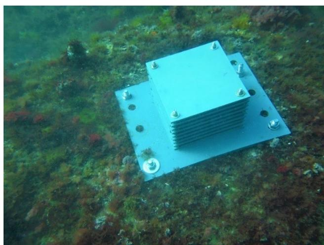
FIGURA 14. EQUIPO DE ARMS INSTALADO
